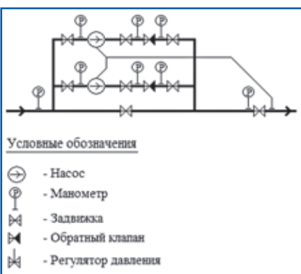
Рис.1. Гидравлическая схема станции II водоподъёма
